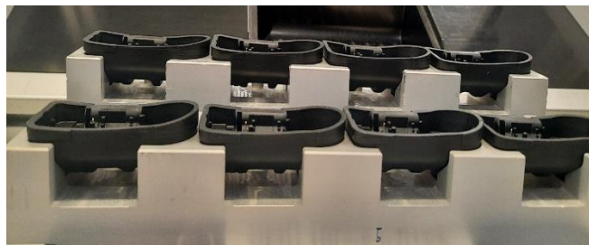
Ilustración 42 piezas bien colocadas en pallet
