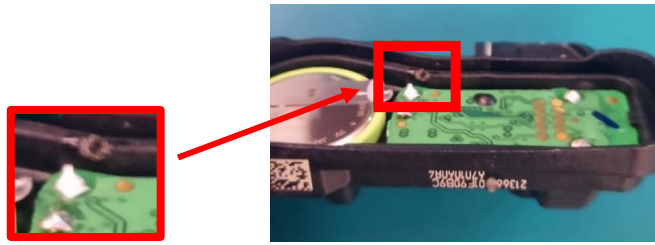
Ilustración 18 Falla Enclosure Dañado
